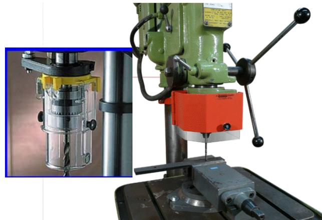
Korišćenje **pomoćnog alata** za pridržavanje radnog predmeta tokom obrade
